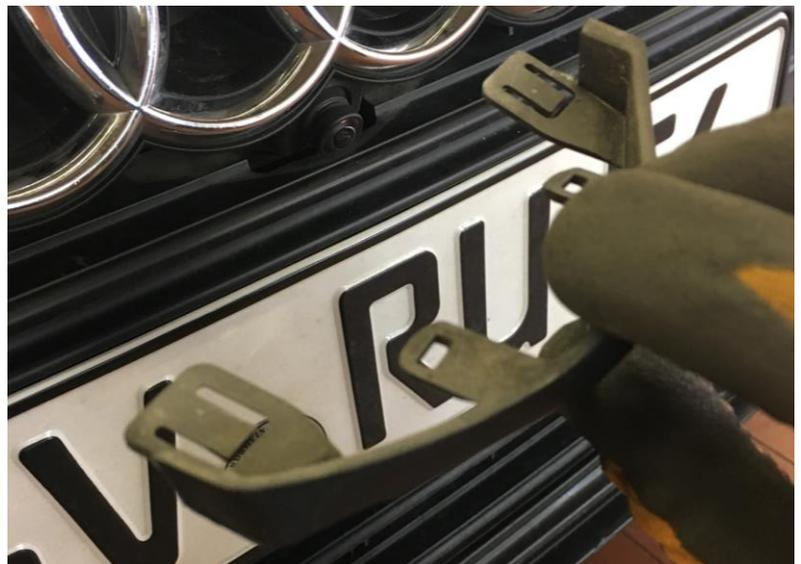
Jetzt ist die obere Schicht des Kühlergrills gelöst und soweit locker, dass man die Kamera in der Mitte rausziehen kann.
