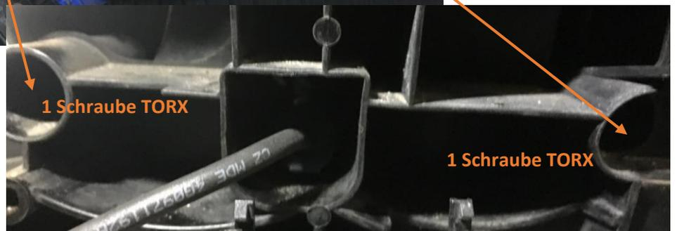
Nun lässt sich die Erste Schicht des Kühlergrills soweit lösen, dass man an die Kamera dran kommen kann.
